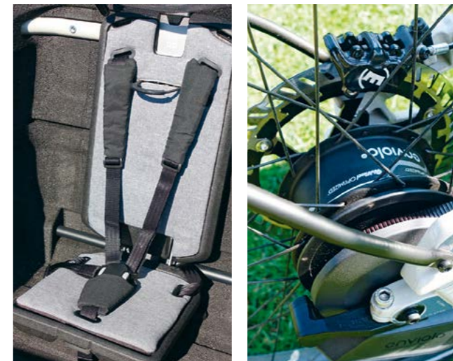
Die Passagiere werden mit Fünf-Punkt-Gurt und Kopfstützen am Sitz gesichert (links). Die Automatikschaltung (rechts) kommt von Enviolo
